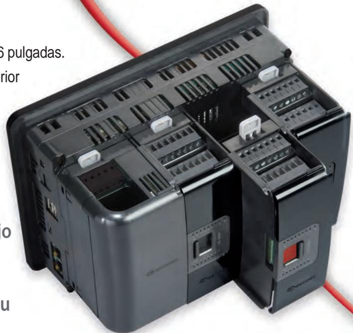
Módulos E/S y Módulos de comunicación que son fáciles de conectar en la parte posterior del panel HMI sin necesidad de mover las unidades vecinas.
